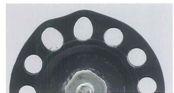
バフと塗膜との接触面積を増やすための自由に伸縮する外周部。
